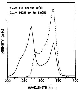
Fig. 2b. Excitation spectra of 100 ppm Eu<sup>3+</sup> (---) and Sm<sup>3+</sup> (---) solution.
