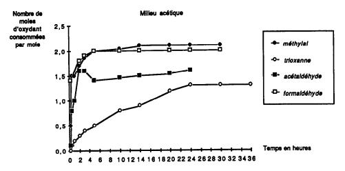
Fig. 2. Cinétique d'oxydation d'aldéhydes et de derivés.
