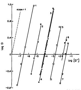
Fig. 5. Plots of  $\log D$  vs.  $\log[Q^+]$ .  $[Cl^-] = 0.1M$ ,  $Q^+$ : 1 ( $\bigcirc$ ) TAA<sup>+</sup>, 2 ( $\bigcirc$ ) TDTMA<sup>+</sup>, 3 ( $\triangle$ ) DDTMA<sup>+</sup>, 4 ( $\triangle$ ) TBA<sup>+</sup>, 5 ( $\square$ ) DTMA<sup>+</sup>, 6 ( $\square$ ) TPA<sup>+</sup>, 7 ( $\nabla$ ) OTMA<sup>+</sup>.
