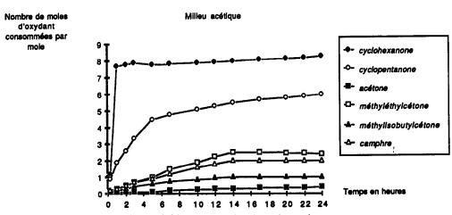
Fig. 3. Cinétique d'oxydation de quelques cétones.
