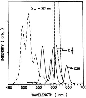
Fig. 2a. Emission spectra of 1000 ppm  $UO_2^{2+}$  (---), 100 ppm  $Eu^{3+}$  (---), and 100 ppm  $Sm^{3+}$  (---) solution.
