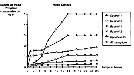
Fig. 1. Cinétique d'oxydation de quelques alcools.
