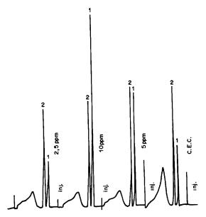
Fig. 1. Chromatogramme de l'oxyde d'éthylène  $(1, t_R = 0.8 \text{ min})$  en présence d'étalon interne: oxyde de propylène  $(2, t_R = 1 \text{ min})$ .
