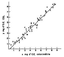
Fig. 2. Droite de corrélation entre les résultats obtenus par colorimétrie et par CGL (y = 0.98x - 0.17; r = 0.98).
