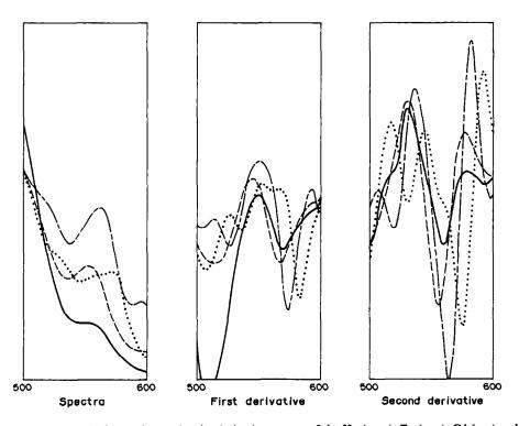
Fig. 5. Ordinary and first and second order derivative spectra of the Hg (-----), Zn (----), Cd (----) and Ni (...) PAN-CTMAB systems.
